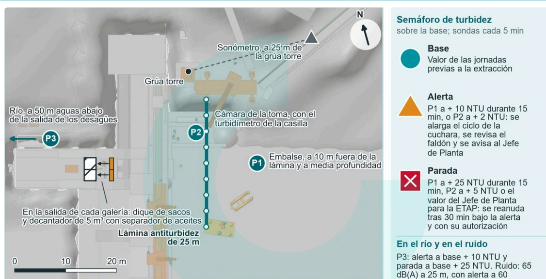
Figura 3.1. P1 (embalse, a 10 m fuera de la lámina y a media profundidad), P2 (cámara de la toma) y P3 (río, 50 m aguas abajo) medirán la turbidez; alerta a +10 NTU durante 15 min en P1 (+2 en P2) y parada a +25 NTU (+5 en P2) sobre la base, con dique de sacos y decantador de 5 m³ en cada galería y sonómetro a 25 m de la grúa torre.
