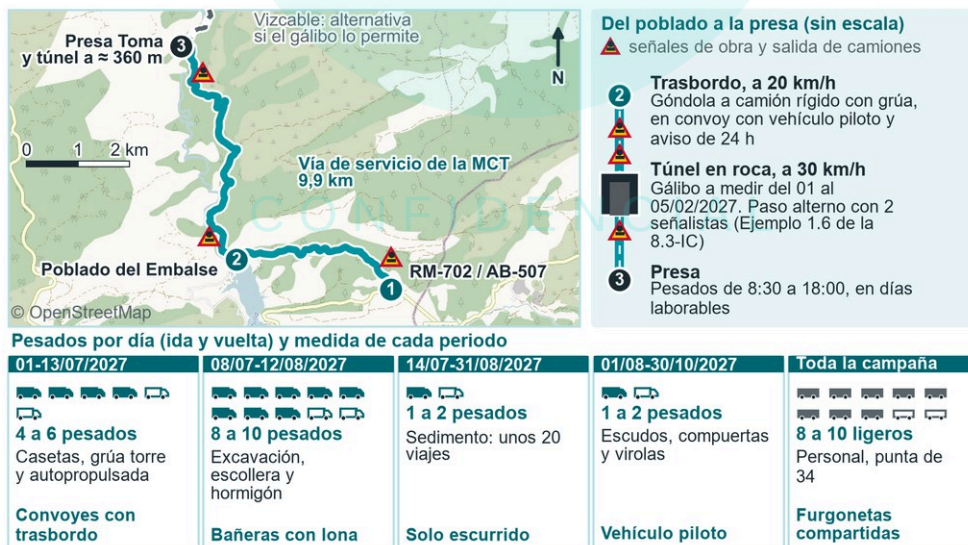
Figura 1.3. La obra entrará por la RM-702 / AB-507 y 9,9 km de vía de la MCT, con trasbordo en el poblado del Embalse y paso alterno con dos señalistas en el túnel; los pesados circularán de 8:30 a 18:00 en días laborables, de 1 a 10 por día según el periodo.
