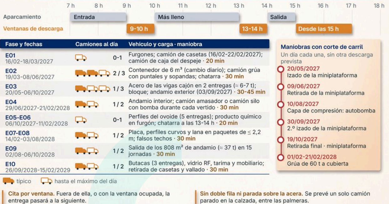
Figura 1.8. Descargas en C/ Bravo Murillo. Cada camión vendrá citado a una de las tres ventanas del día, que evitarán la entrada, la punta y la salida del aparcamiento; en las seis maniobras de un día la calzada se reservará para esa maniobra, con corte de carril autorizado.
