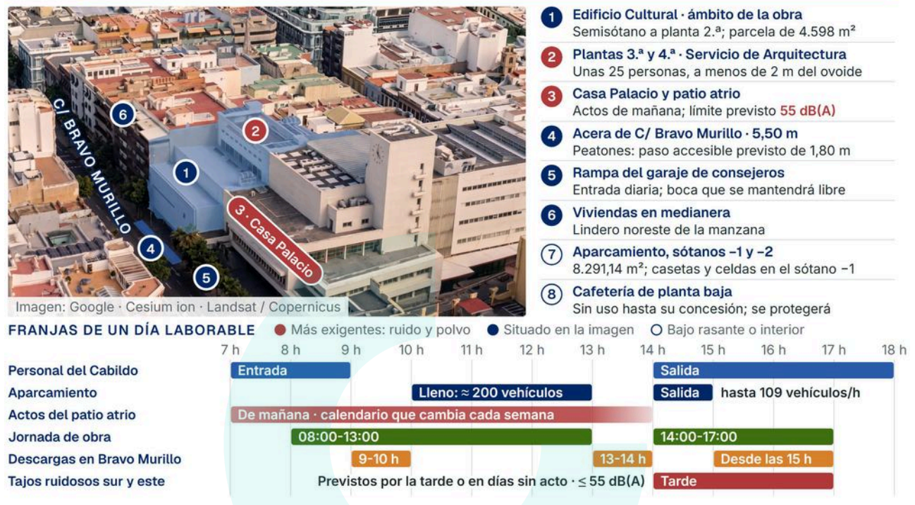
Figura 1.5. Usos que convivirán con la obra y sus horarios. La UTE concentrará las descargas en las ventanas de 9-10 h, 13-14 h y desde las 15 h, y llevará los tajos ruidosos de los bordes sur y este a la tarde o a los días sin acto, por debajo de 55 dB(A) en el lado del atrio.
